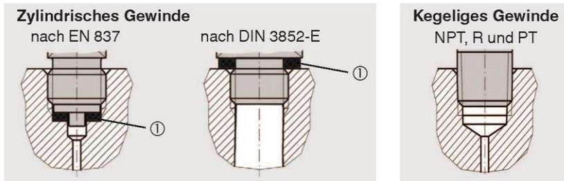
Zur Abdichtung der Prozessanschlüsse mit zylindrischem Gewinde an der Dichtfläche ① sind Flachdichtungen, Dichtlinsen oder WIKA-Profilabdichtungen einzusetzen.
